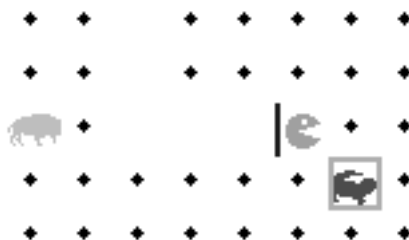
FIG. 6. Illustration d'une situation où le mécanisme d'interaction cross-modale intervient. Un animal proche (crocodile) est hors du champ visuel. Le robot l'entend et redéclenche une procédure de vision.
